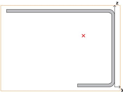
Ребро кассеты МП 1005; МП 2005  $t=1,0\text{мм}$
