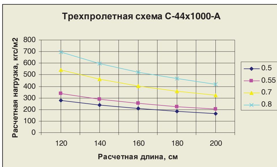
Расчетная нагрузка  $q$ , кгс/м<sup>2</sup>
