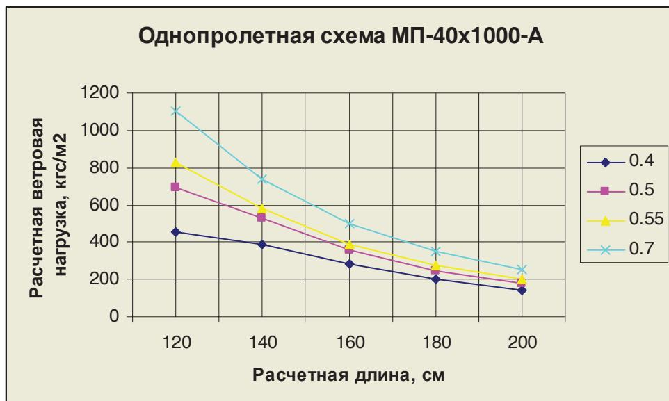
Расчетная нагрузка  $q$ , кгс/м<sup>2</sup>
