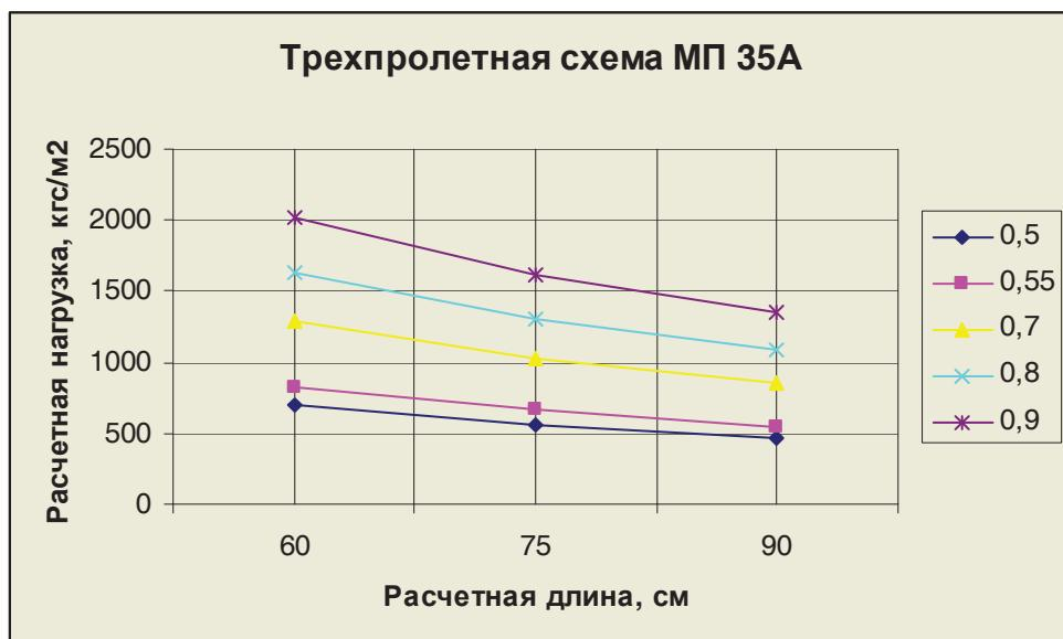
Расчетная нагрузка  $q$ , кгс/м<sup>2</sup>
