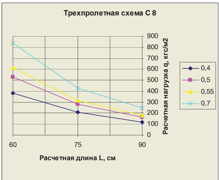
Расчетная нагрузка  $q$ , кгс/м<sup>2</sup>
