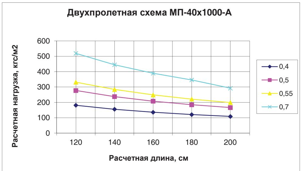
Расчетная нагрузка  $q$ , кгс/м<sup>2</sup>
