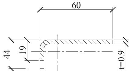
Эффективная ширина полки при расчете профиля по несущей способности:
