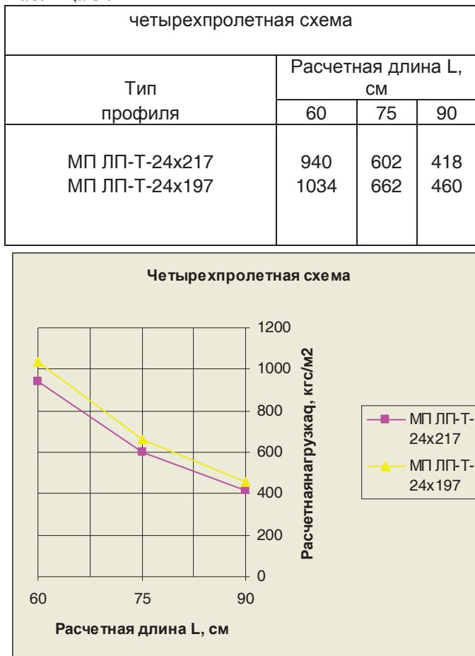
Расчетная нагрузка  $q$ , кгс/м<sup>2</sup>
