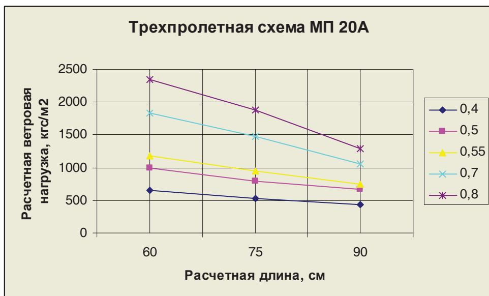
Расчетная нагрузка  $q$ , кгс/м<sup>2</sup>
