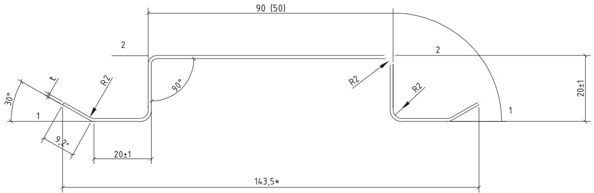
Толщина  $t = 1,2 \text{ мм}$
