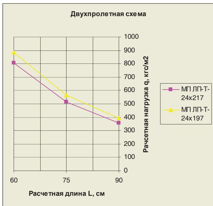
Расчетная нагрузка  $q$ , кгс/м<sup>2</sup>
